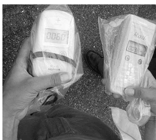
2台の放射線測定器の平均値をみます。0.060と0.036μSvの数字が見えます=福山市役所
