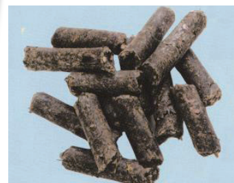
RDF(ゴミ固形燃料)=可燃ゴミを乾燥させクレーン状に固めた燃料。
